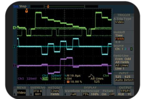
► **Figura 58.** Il modulo video TDS3SDI trasforma l'oscilloscopio serie TDS3000 in uno strumento rapido e accurato per la ricerca guasti in impianti video.
