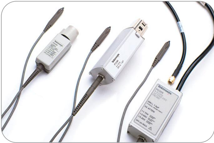
► **Figura 44.** L'interfaccia Tektronix TekConnect™ preserva l'integrità del segnale fino a 10 GHz e oltre, per rispondere alle necessità attuali e future relative alla larghezza di banda.
