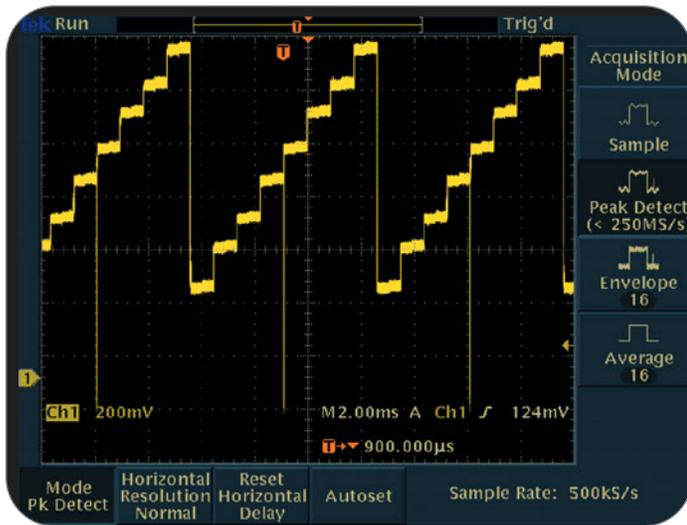
► **Figura 25.** Esempio di un menu di acquisizione.
