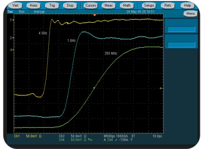
► **Figura 47.** Quanto più ampia è la larghezza di banda, tanto più precisa è la riproduzione del segnale, come illustrato nel caso di un segnale acquisito con larghezze di banda pari a 250 MHz, 1 GHz e 4 GHz.
