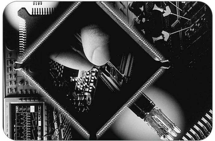
► **Figura 45.** Gli adattatori Tektronix SF200A e SF500 serie SureFoot™ permettono di connettere in modo affidabile il puntale di una sonda con cavo corto a un pin specifico di un circuito integrato.
