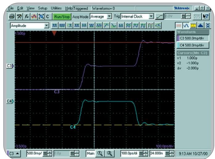
► **Figura 21.** La schermata di un riflettometro nel dominio del tempo (TDR) ottenuta con un oscilloscopio a memoria digitale TDS8000 e un modulo campionatore a 20 GHz 80E04.
