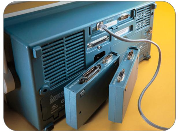
► **Figura 55.** Un oscilloscopio serie TDS3000 offre svariate interfacce di comunicazione, quali una porta Centronics standard e moduli opzionali Ethernet/RS-232, GPIB/RS-232 e VGA/RS-232.
