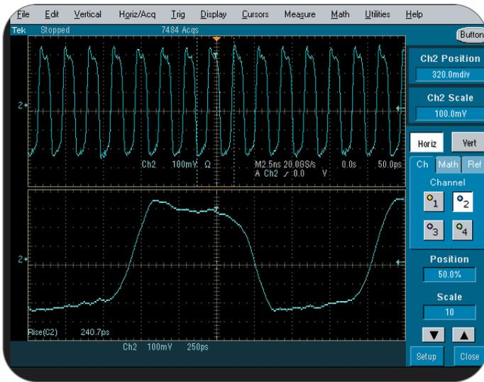
► **Figura 48.** Caratterizzazione del tempo di salita di un segnale digitale ad alta frequenza.
