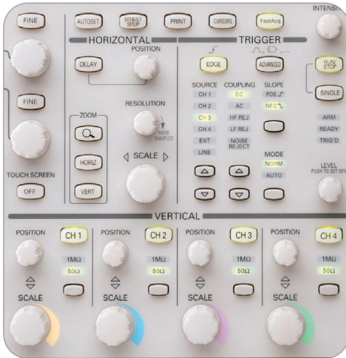
► **Figura 22.** Sezione di comando (pannello anteriore) di un oscilloscopio.
